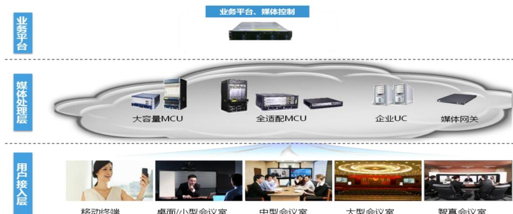
图10 视频通信架构示意图
