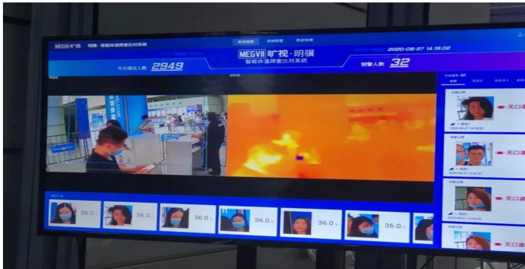
图 8：人脸识别+红外/可见光双传感系统示意图
