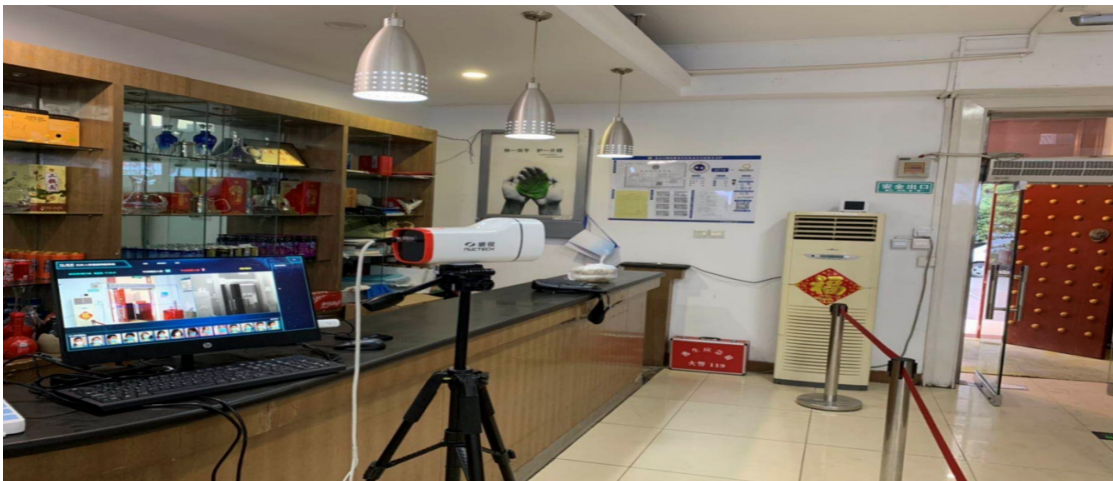
图 7：非黑体红外体温筛查相机系统示意图
